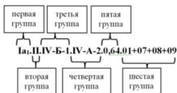
Рисунок 4.1 – Примеры кодифицированных буквенно-цифровых записей об инженерно-геологических, грунтовых и сейсмических условиях двух строительных площадок
